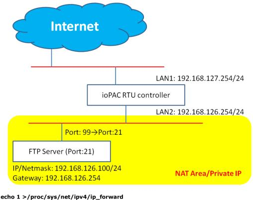
modprobe ip\_tables modprobe nf\_conntrack modprobe nf\_conntrack\_ftp modprobe nf\_conntrack\_irc modprobe iptable\_nat modprobe nf\_nat\_ftp modprobe nf\_nat\_irc iptables -t nat -A PREROUTING -p tcp --dport 99 -i eth0 -j DNAT --to-destination 192.168.126.100:
